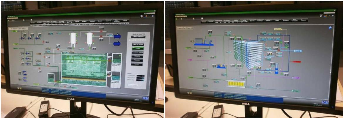
**Ilustración 33: SCADA -Supervisión, Control y Adquisición de Datos- Software para controlar el proceso productivo de una planta desaladora.**
