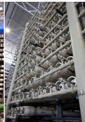
**Ilustración 14: Bastidor de membranas.**
