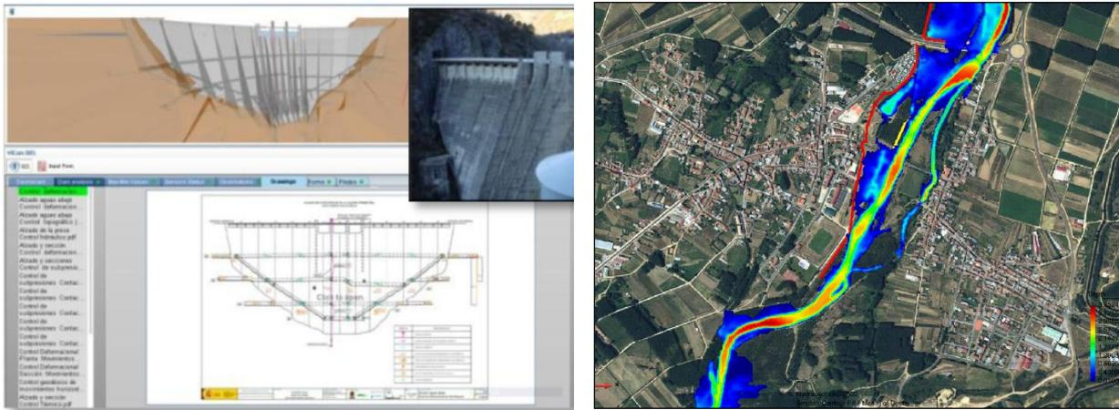
**Ilustración 3: Modelo de comportamiento estructural de una presa y modelación hidráulica asociada para un proyecto de optimización y mejora de las infraestructuras de defensa de inundaciones existentes.**
