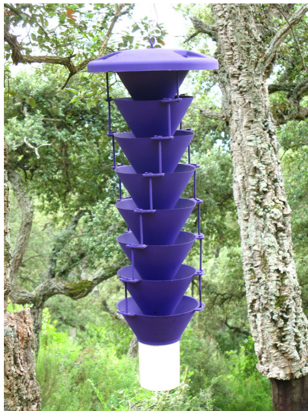
Fotos 11-12. Detalle de la trampa Lindgren de color negro y violeta utilizadas durante la campaña del 2008
