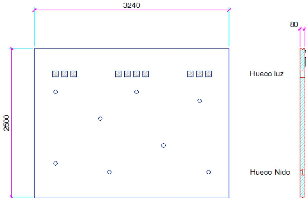
Figura 4: Dimensiones del panel prefabricado y secciones
