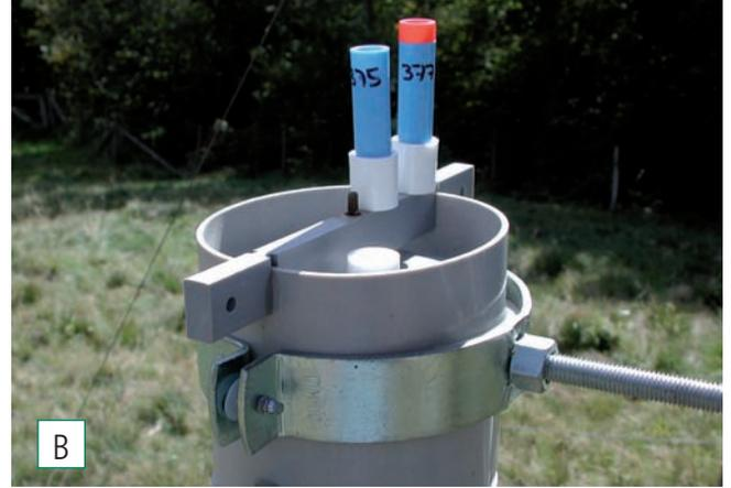
Ejemplos de diferentes aparatos de muestreo usados en Parcelas de Seguimiento Intensivo en Europa. A) Francia, B) y C) Suiza, D) España. Los dosímetros pasivos proporcionan un método preciso y barato para medir exposiciones acumuladas de diferentes contaminantes atmosféricos como el ozono y no requieren energía eléctrica. Las moléculas de ozono se difunden dentro del aparato donde son absorbidas. Tras el análisis en laboratorio dan un valor de concentración medio a lo largo del tiempo.
