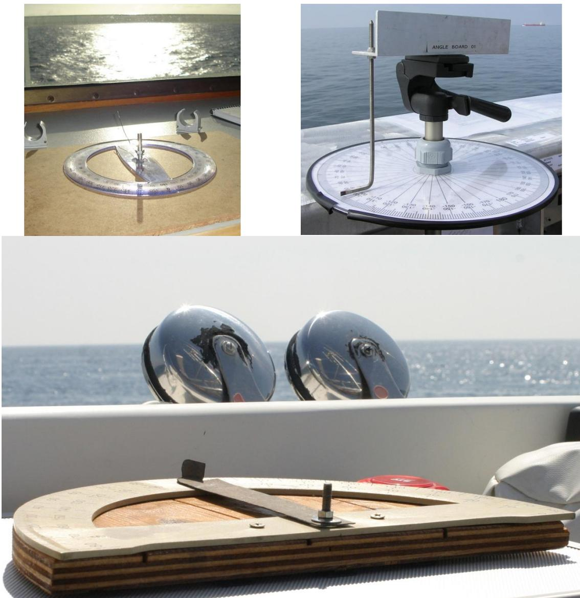
Figura 6.6: Diferentes modelos de angulómetros.
