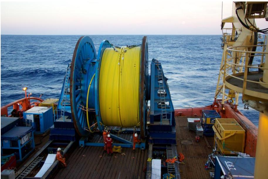
Figura 3.7: Imagen de una embarcación durante el tendido de tuberías durante la fase de explotación de una plataforma petrolífera. ©SUBMON®
