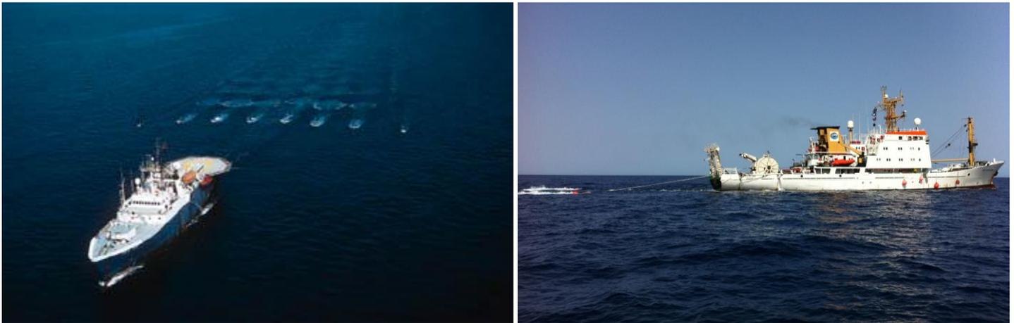
Figura 3.5: Izquierda; Imagen de un barco arrastrando una ristra de cañones de aire comprimido para una prospección de sísmica 3D, ©Schlumberger. Derecha; Imagen de un barco arrastrando dos cañones de aire comprimido realizando una prospección de sísmica 2D, ©SUBMON®
