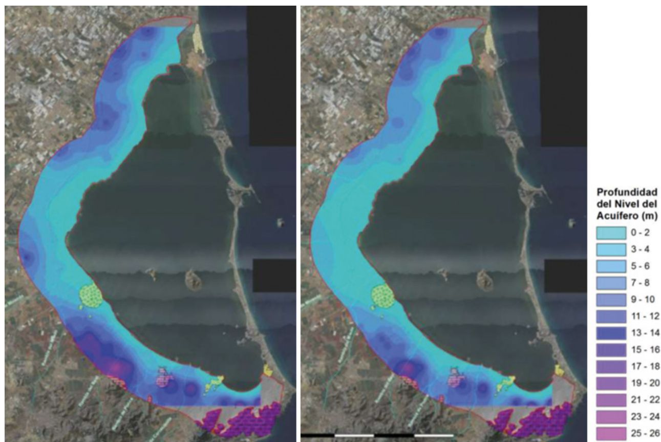
Figura 7. Mapas de isoprofundidades de la superficie piezométrica del acuífero Cuaternario en el periodo octubre de 2018-octubre de 2019. Fuente: “Cuantificación, control de la calidad y seguimiento piezométrico de la descarga de aguas subterráneas del acuífero cuaternario del Campo de Cartagena al Mar Menor. TRAGSATEC. Marzo 2020.
