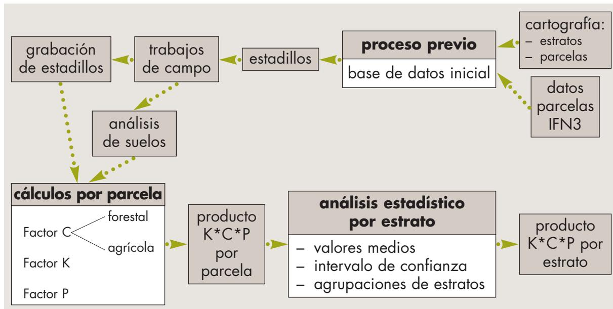
Figura 1. Esquema del proceso de datos del Inventario Nacional de Erosión de Suelos.
