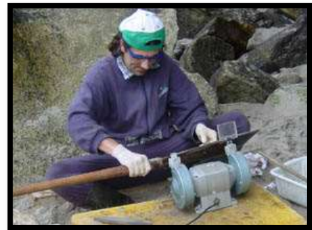
Figuras 14 y 15 Equipo de sujeción, empleando ganchos metálicos para facilitar el trabajo del equipo de corte y afilado de una lanza de corte con un esmeril eléctrico. Necropsia de un rorcual común. Niño do Corvo, Ponteceso, A Coruña.
