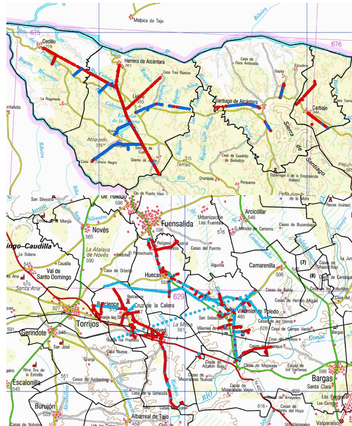
Figuras A3.2 y 3: Apoyos eléctricos seguidos en Cáceres (TTMM de Carbajo, Cedillo, Herrera de Alcántara y Santiago de Alcántara) y Toledo (TT.MM. de Barciene, Huecas, Rielves y Villamiel). En rojo se muestran los apoyos que no cumplen las exigencias del R.D. 1432/2008 y en azul los que sí
