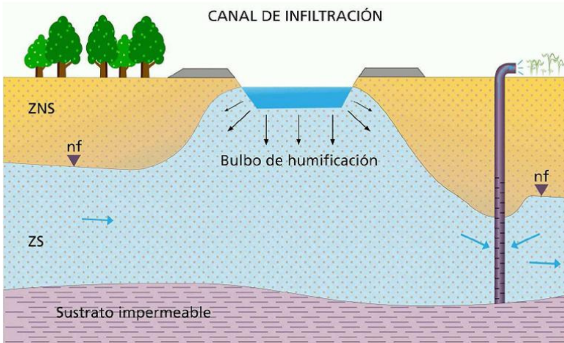
Esquema de un dispositivo de AR tipo canal de infiltración. (Fuente: Tragsatec)
