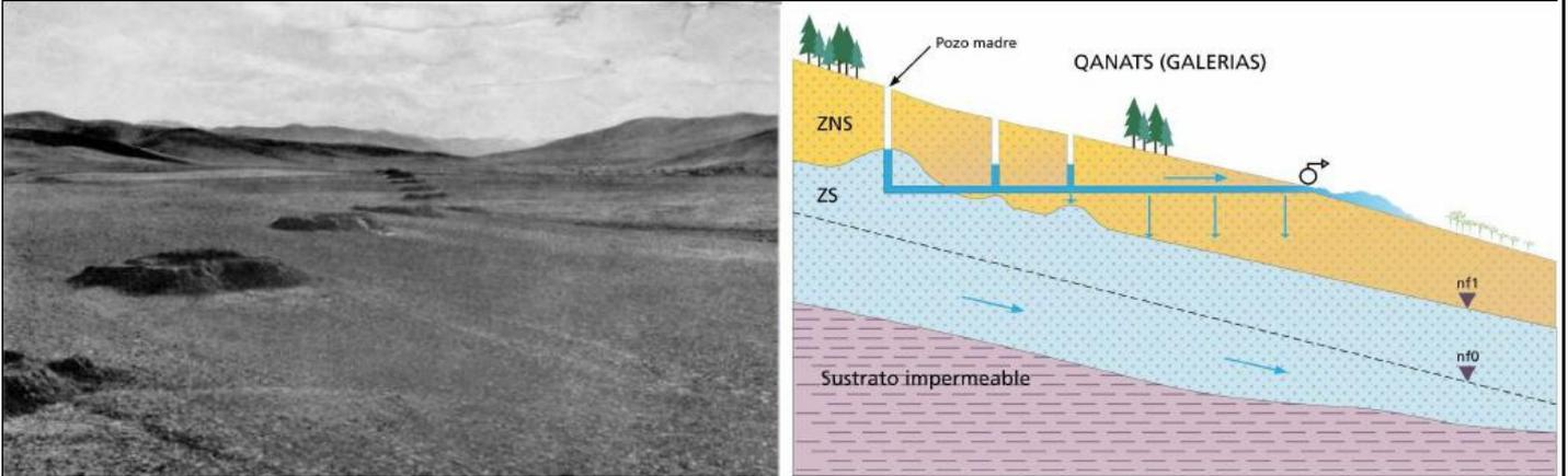
*Serie de pozos que forman parte de un qanats y esquema de un dispositivo de recarga mediante Qanats. Estos pozos están contruidos para la ventilación y extracción del material excavado.*
