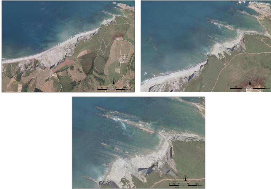
**Figura 21** Imágenes aéreas de un tramo de la costa de Zumaya (Guipúzcoa) a escalas a 1:5.000, 1:2.000 y 1:1.000, respectivamente. La cartografía del acantilado es posible a cualquier escala, aunque la plataforma solamente es cartografiable con ciertas garantías a escala 1:1.000. Fuente: elaboración propia a partir de ortofotografías del PNOA.
