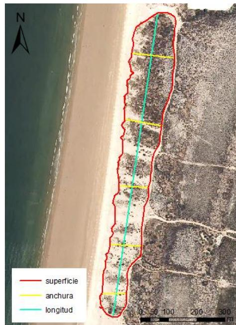
**Figura 3** Ejemplo de medición de las variables morfosedimentarias obligatorias en las dunas costeras de Valdelagrana (Cádiz). Fuente: elaboración propia a partir de ortofotografía del PNOA.
