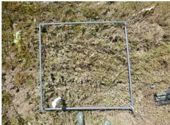
**Figura 7** Área mínima de control utilizada en la evaluación del estado de una marisma en la bahía de Cádiz para el proyecto FAST (*Foreshore Assessment using Space Technology*)<sup>11</sup> con dimensiones de 1x1 m. Fuente: extraída de los productos multimedia disponibles del proyecto FAST.
