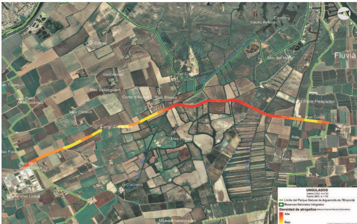
Figura 4.10. Ejemplo de identificación de un tramo de concentración de colisiones con ungulados (en rojo y naranja fuerte) mediante el análisis con SIG de los datos de accidentes. Fuente: Minuartia-Universitat Politècnica de València (2011)
