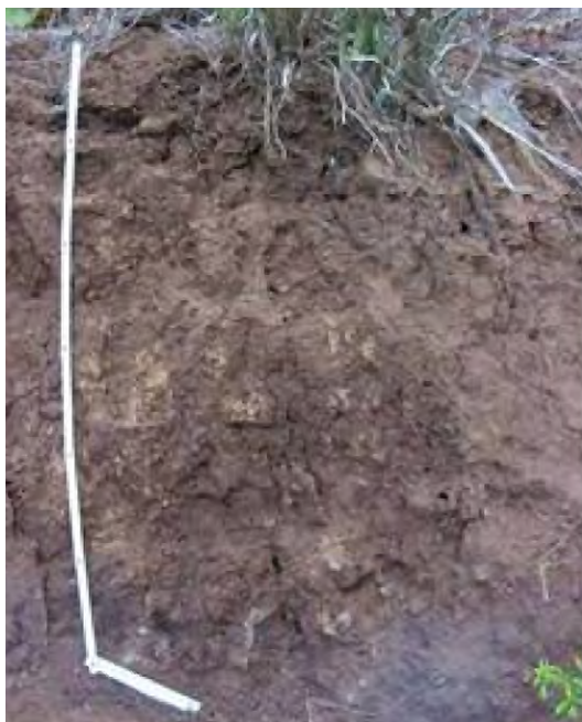
Perfil SAN GONZALO (Tegueste) Tenerife, islas Canarias. X: 366907 Y: 3155183 WRB: Luvisol vértico (sódico, arcilloso)
