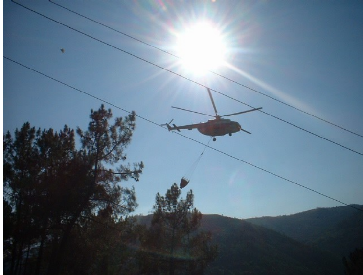
Foto 7 Los cables eléctricos suponen siempre un riesgo para los medios aéreos.
