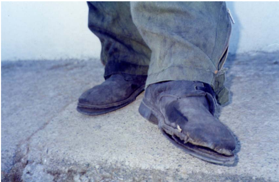
Foto 3: Efecto de las altas temperaturas del suelo sobre las botas
