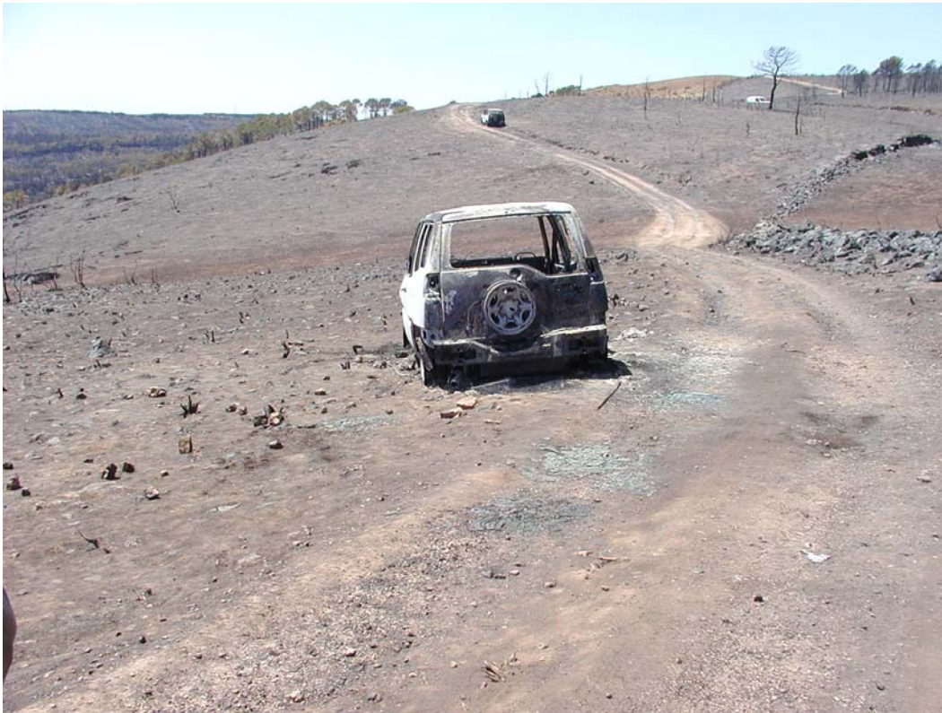
Foto 16 La posición de los cristales en el suelo indican que el vehículo que se hallaba en movimiento cuando fue alcanzado por el calor radiante de las llamas. Cualquier objeto puede aportar una información muy valiosa para la investigación.
