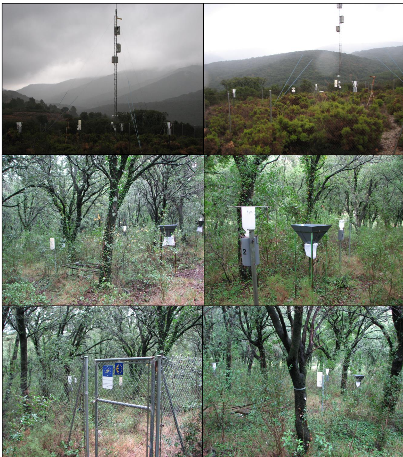
FIG 7: Parcela exterior. Torre meteorológica y captadores. Parcela interior. Acumuladores de deposición. Captador de desfronde. Pluviómetro. Dieldendro
