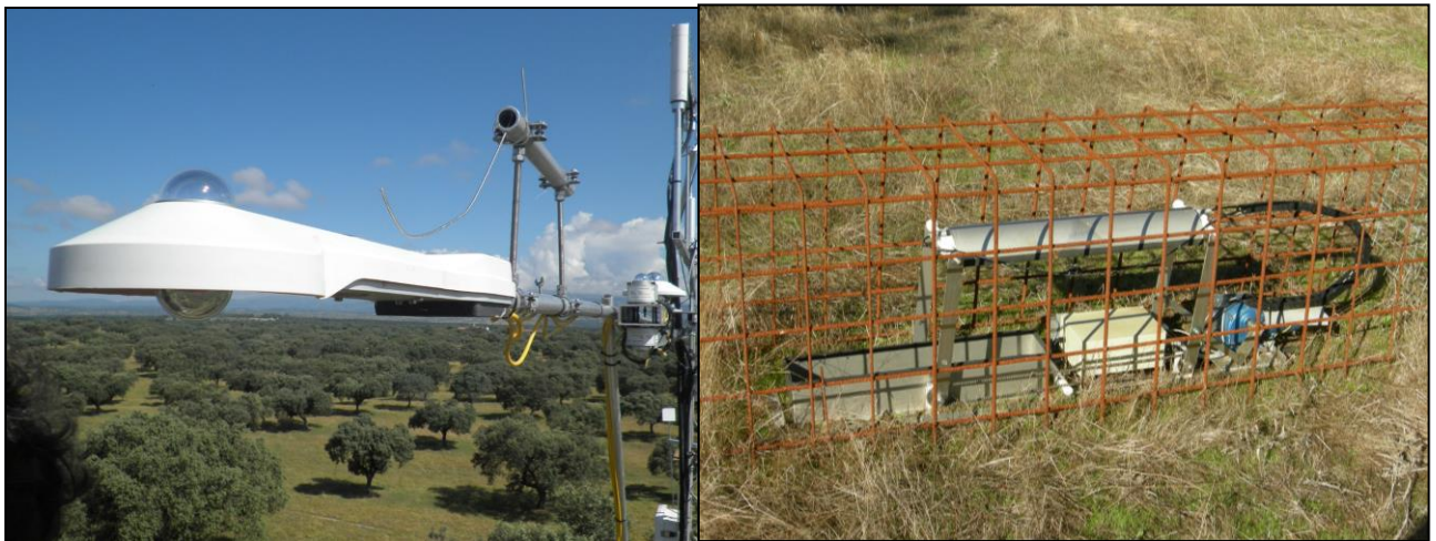
FIG 7b: Instrumentación para medición de radiación solar e infrarroja. Respirador de suelo.
