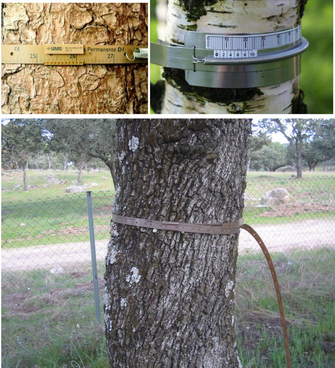
**Figura 1: Tipos de dendrómeto**
