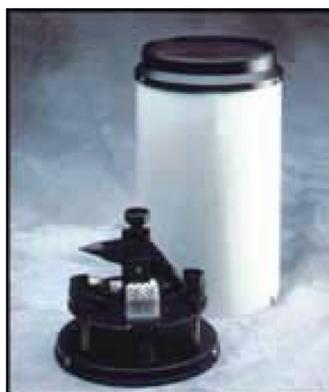
**Figura 5. Pluviómetro automático.**
