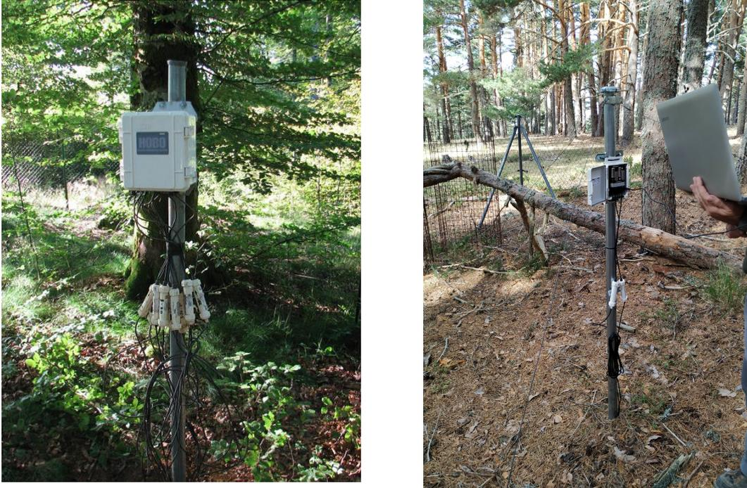
**Figura 7: Unidad de almacenamiento y proceso de datos para extracción de datos de humedad y temperatura del suelo**
