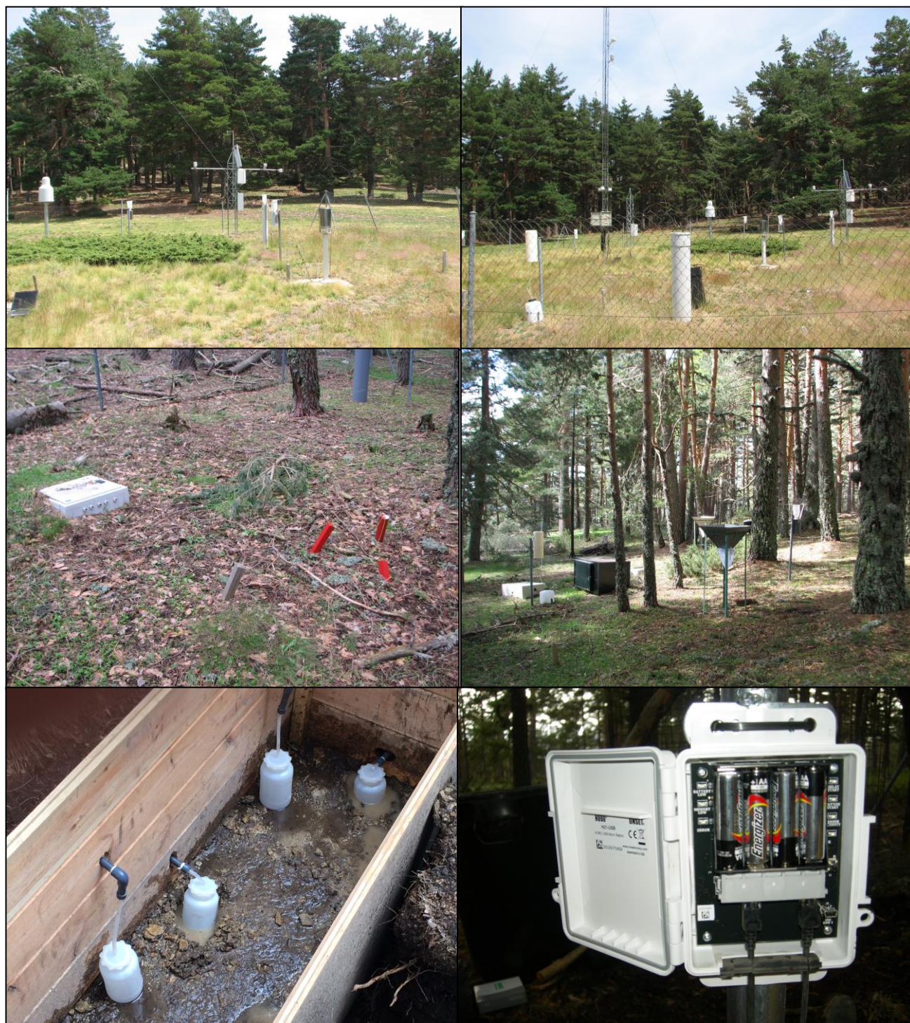
FIG 7: Parcela exterior. Pluviómetros, captadores e instrumentación meteorológica. Parcela interior. Lisímetros, sondas de humedad, captadores de desfonde y acumuladores. Lisímetro de gravedad. Sonda de humedad y temperatura del suelo
