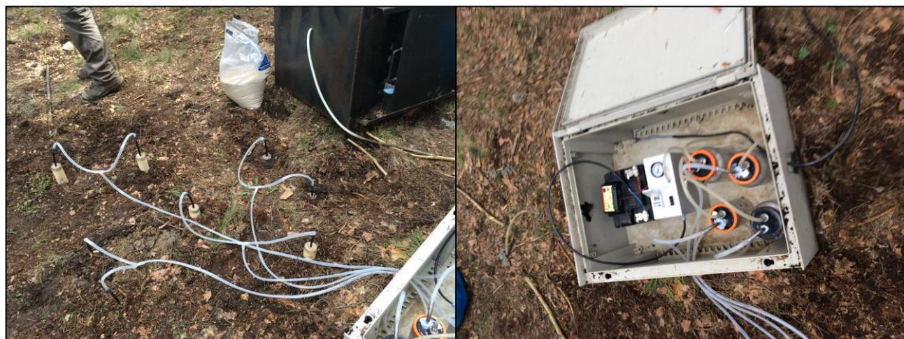
FIG 39: Lisímetros de tensión para extracción de agua del suelo y bomba de vacío
