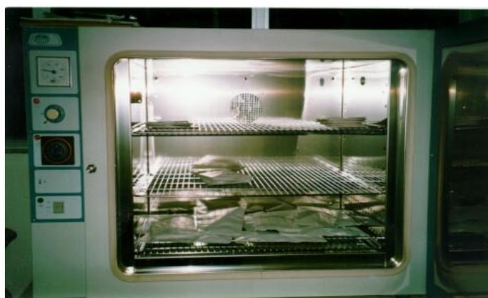
**Fotografía 1.** Estufa de ventilación forzada utilizada en el ensayo.
