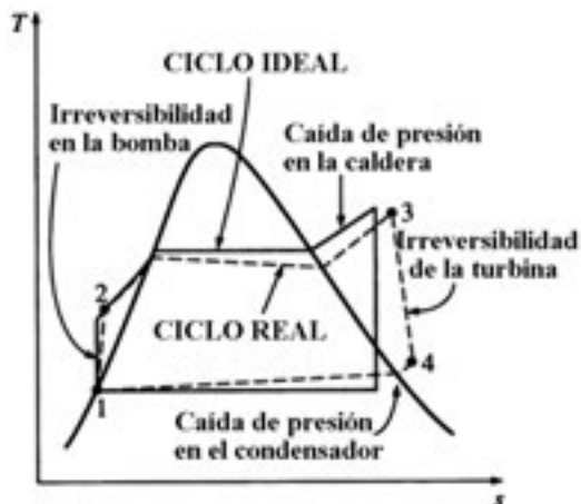
Figura 10.3: Desviación de un ciclo real de energía de vapor con respecto al ciclo ideal de Rankine
