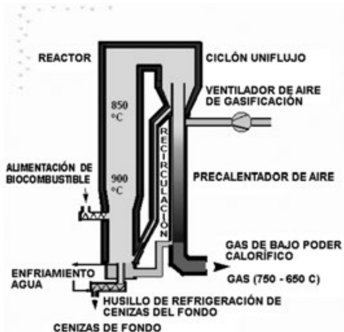
Figura 5.4: Gasificador Foster Wheeler [192, GTT, 2003]
