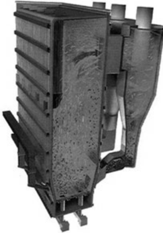
Figura 5.7: Flujo del material del lecho y del combustible en una caldera de CLFC que utiliza biomasa como combustible [91, Kokk et ál., 2000]
