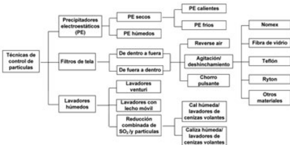
Figura 3.1: Visión general de los dispositivos de control de partículas que se utilizan actualmente
