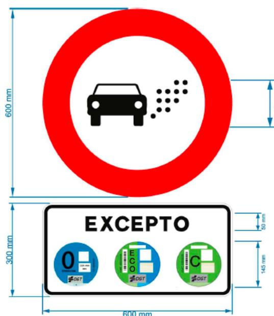
Ilustración 2. Diseño de señal aprobado por la DGT.
