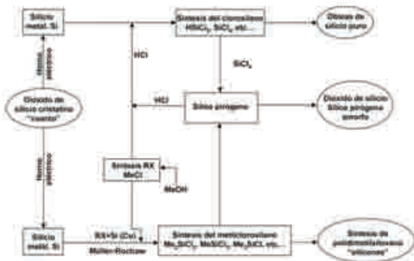
Figura 5.7: Procedimientos utilizados para materias primas en la producción de sílice pirogénica. [49, CEFIC-ASASP, 2002]
