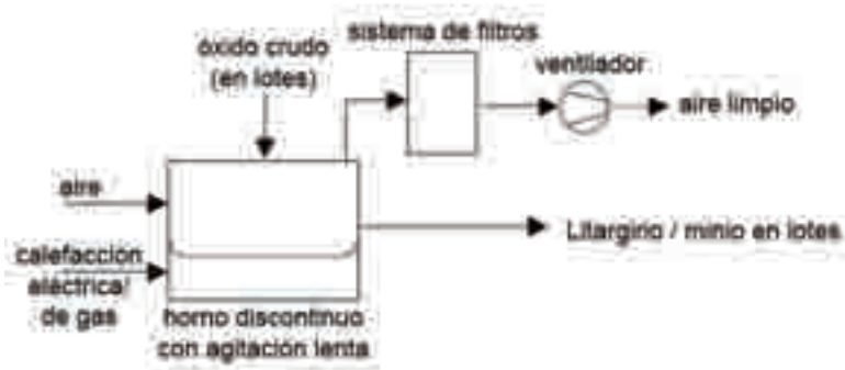
Figura 7.16: Oxidación secundaria en un horno discontinuo [96, CEFIC-ELOA, 2004]
