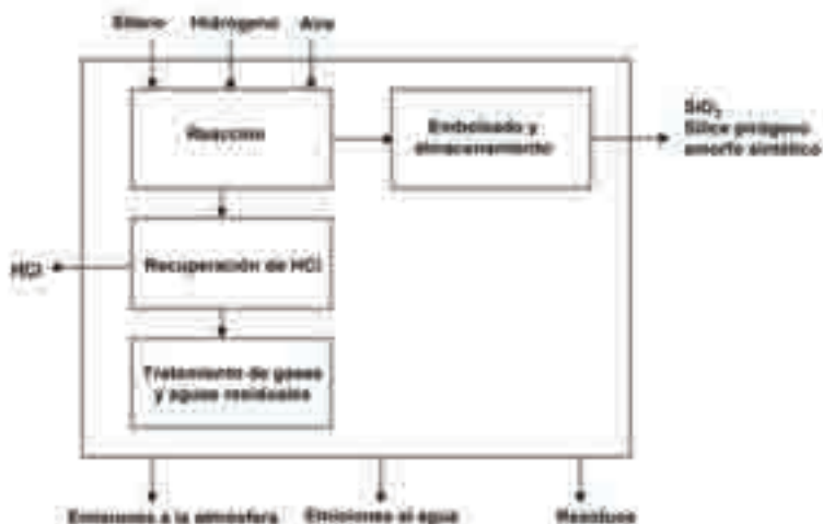
Figura 5.8: Principales unidades de una planta de sílice amorfa sintética pirogénica [49, CEFIC-ASASP, 2002]
