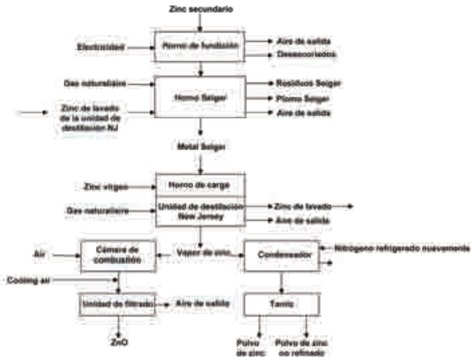
Figura 7.50: Diagrama de flujo del proceso que muestra la producción de ZnO mediante el proceso de rectificación [62, CEFIC-ZOPA, 2004]
