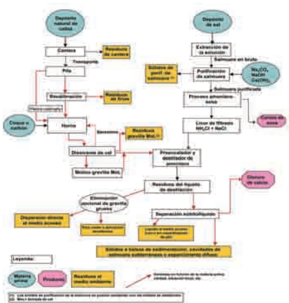
Figura 2.4: Interrelaciones entre materias primas, productos y residuos en la producción de carbonato de sodio [108, CEFIC-ESAPA, 2005]
