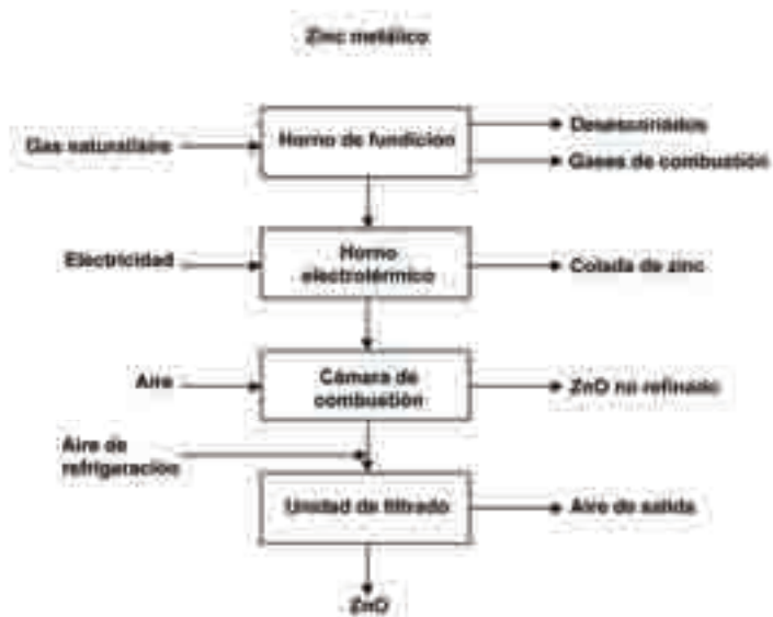
Figura 7.48 : Diagrama de flujo del proceso que muestra la producción electrotérmica de ZnO [62, CEFIC-ZOPA, 2004]
