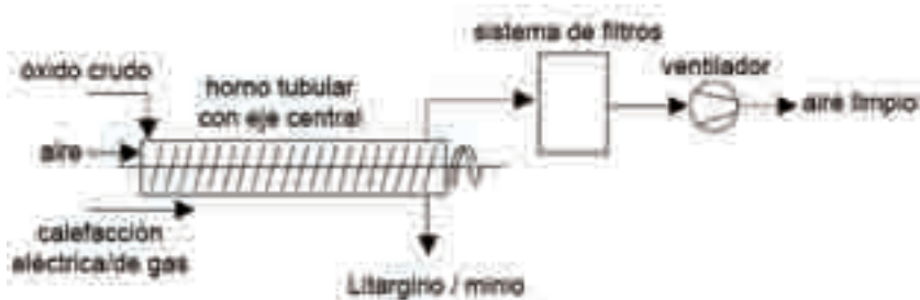
Figura 7.17: Oxidación secundaria en un horno tubular [96, CEFIC-ELOA, 2004]
