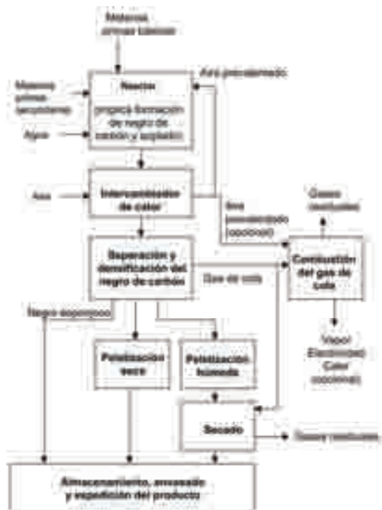
Figura 4.3: Ejemplo de posible configuración del proceso de negro de horno. [47, InfoMil, 2002]
