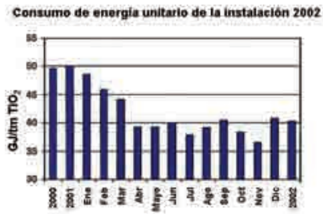
Figura 3.9: Consumo de energía unitario de la producción del TiO_2 mediante el procedimiento del sulfato en la planta de Grimsby [20, CEFIC-TDMA, 2004]
