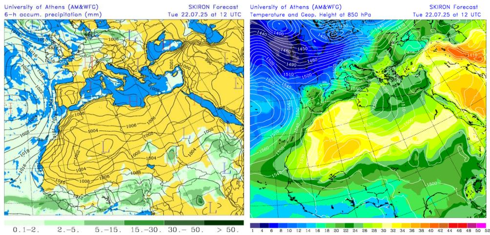
Precipitación acumulada (mm) y presión a nivel del mar (hPa) (izquierda) y campo de temperaturas ( $^{\circ}\text{C}$ ) y de altura geopotencial a 850 hPa (derecha) previsto por el modelo SKIRON para el día 22 de julio de 2025 a las 12 UTC © Universidad de Atenas.
