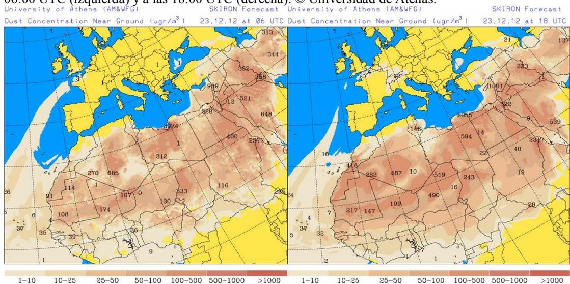
El modelo Skiron prevé concentraciones de polvo a nivel de superficie de entre 1 y 10  $\mu\text{g}/\text{m}^3$  en Canarias durante la primera mitad del día 23 de diciembre de 2012, y de entre 1 y 25  $\mu\text{g}/\text{m}^3$  durante la segunda mitad del día.
