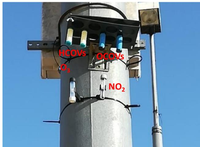
Figura 7. Dosímetros Gradko (para O<sub>3</sub> y NO<sub>2</sub>) y Radiello (para COVs) instalados en un emplazamiento de medida.
