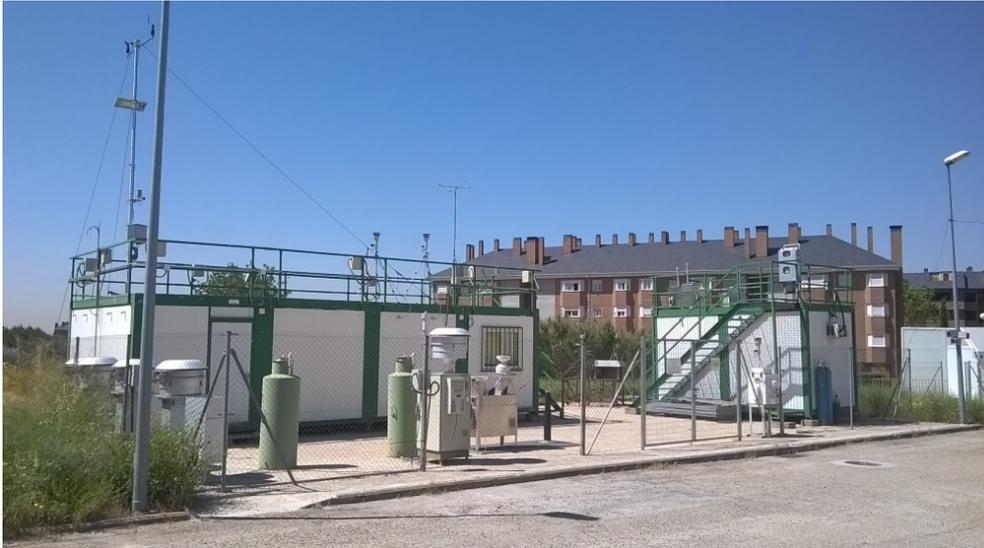
Figura 3.10. Cabinas y captadores de alto y bajo volumen ubicados en la estación del ISCIII en Majadahonda.
