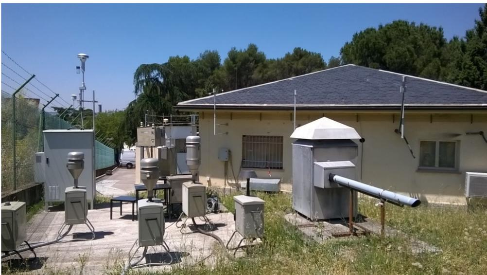
Figura 3.7. Captadores de alto volumen ubicados en la terraza de la estación del CIEMAT
