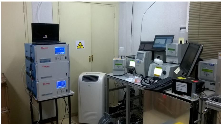
Figura 3.8. Analizadores de NO<sub>x</sub>/NH<sub>3</sub> y O<sub>3</sub> del CSIC y equipos para la medida de la distribución granulométrica de las UFP desde 1nm a 800 nm suministrados por TSI-Álava Ingenieros, instalados en la estación del CIEMAT.
