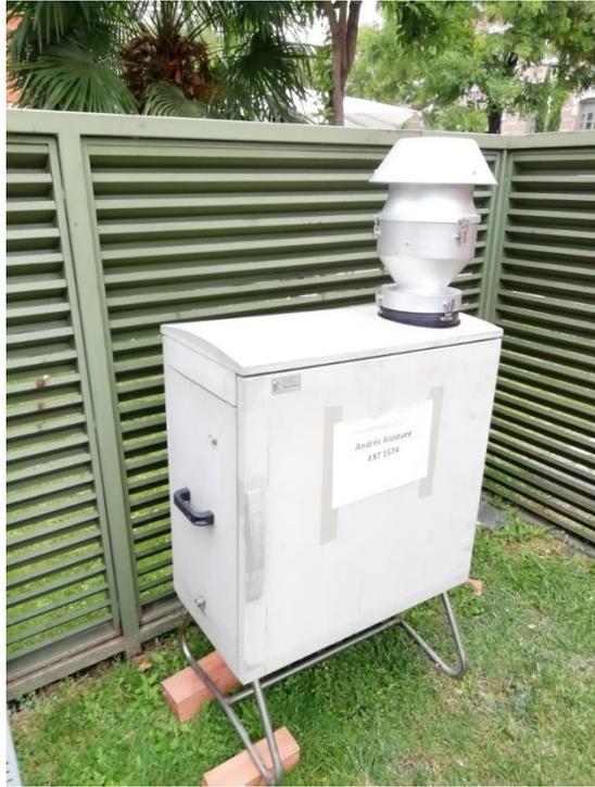
Figura 3. Captador de alto volumen secuencial MCV CAV-A/MSb instalado en la estación de Escuelas Aguirre para realizar el muestreo para llevar a cabo los estudios de contribución de fuentes.
