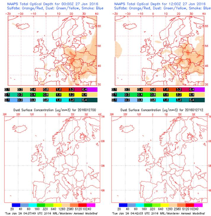
Espesor óptico de aerosoles a 550 nm (arriba) y concentración de polvo a nivel de superficie (abajo) previstos por el modelo NAAPS para el día 27 de enero de 2016 a las 00:00 UTC. ©Naval Research Laboratory (NRL), Monterey, CA.
