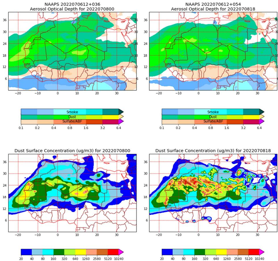
Espesor óptico de aerosoles a 550 nm (arriba) y concentración de polvo a nivel de superficie (abajo) previstos por el modelo NAAPS para el día 08 de julio de 2022 a las 00 UTC (izquierda) y a las 18 UTC (derecha) en el norte de África. ©Naval Research Laboratory (NRL), Monterey, CA.
