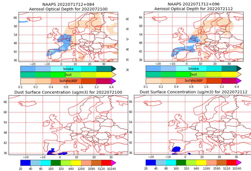
Espesor óptico de aerosoles a 550 nm (arriba) y concentración de polvo a nivel de superficie (abajo) previstos por el modelo NAAPS para el día 21 de julio de 2022 a las 00 h UTC y a las 12 h UTC. ©Naval Research Laboratory (NRL), Monterey, CA.
