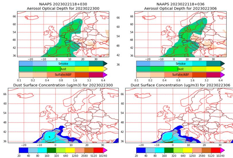
Espesor óptico de aerosoles a 550 nm (arriba) y concentración de polvo a nivel de superficie (abajo) previstos por el modelo NAAPS para el día 23 de febrero de 2023 a las 00 h UTC y a las 6 h UTC. ©Naval Research Laboratory (NRL), Monterey, CA.
