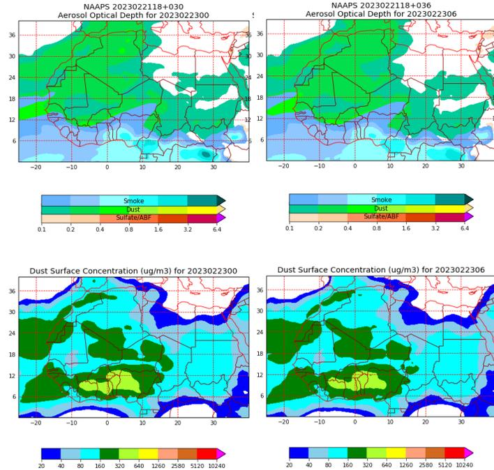
Espesor óptico de aerosoles a 550 nm (arriba) y concentración de polvo a nivel de superficie (abajo) previstos por el modelo NAAPS para el día 23 de febrero de 2023 a las 00 h UTC y a las 12 h UTC. ©Naval Research Laboratory (NRL), Monterey, CA.
