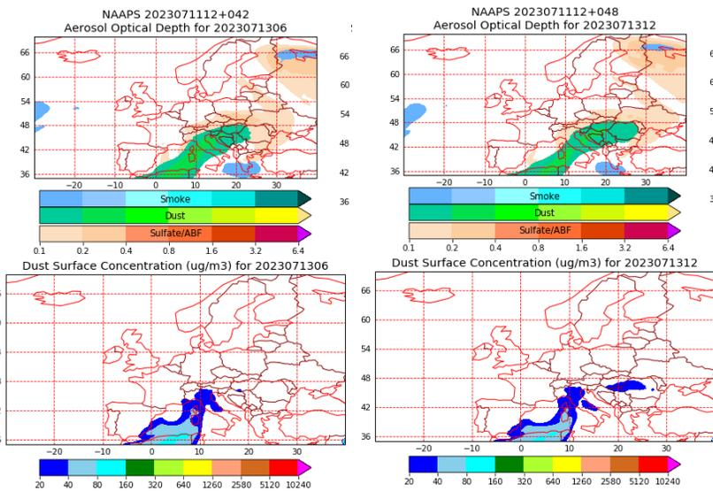
Espesor óptico de aerosoles a 550 nm (arriba) y concentración de polvo a nivel de superficie (abajo) previstos por el modelo NAAPs para el día 13 de julio de 2023 a las 00 h UTC y a las 12 h UTC. ©Naval Research Laboratory (NRL), Monterey, CA.
