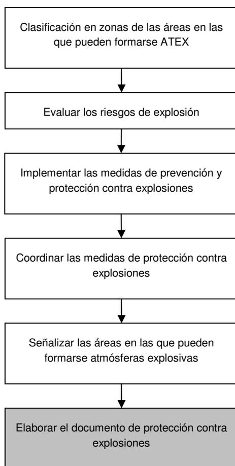
**Figura 3. Obligaciones del operador en materia de prevención y protección contra explosiones. Fuente: RD 681/2003, citado en ASEFAPI, 2009.**
