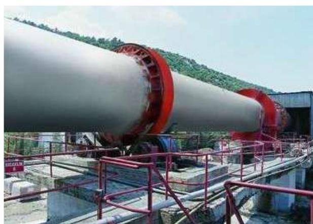
Figura 5. Horno rotatorio para la calcínación de coque de petróleo
