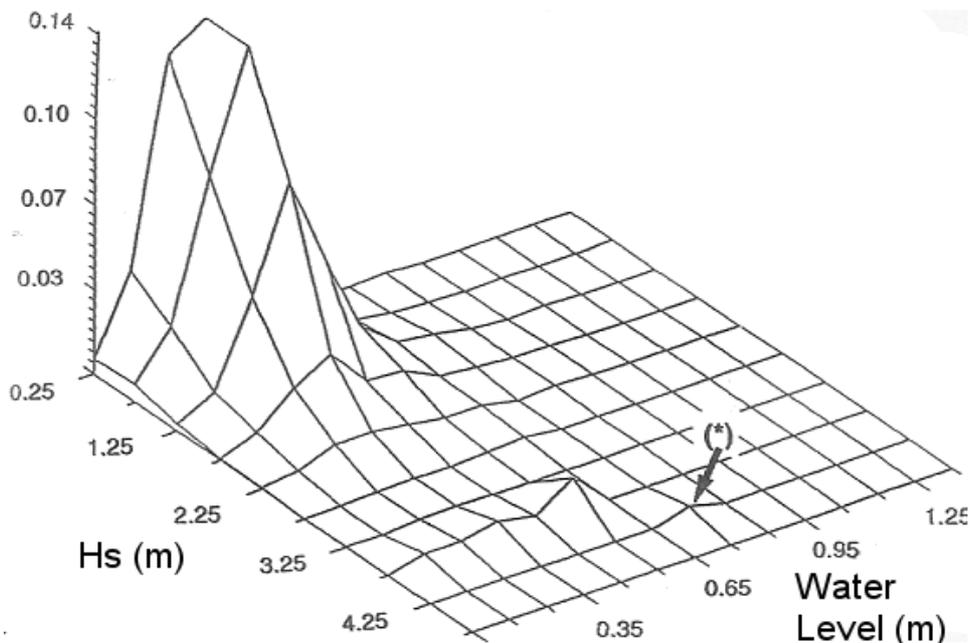
**Fig. 11.9.** Distribución probabilística conjunta de altura de ola significativa ( $H_s$ ) y nivel medio del mar ( $Z$ ). Nota: el asterisco (\*) indica las condiciones que rompieron la barra del Trabucador.
