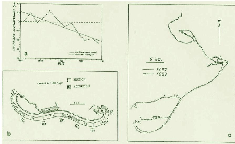
**Fig. 11.4.** Papel del transporte de sedimentos a lo largo de la costa según las diferentes escalas de tiempo: (a) a corto plazo (b) a medio plazo y (c) a largo plazo (adaptada de Jiménez y Sánchez-Arcilla 1993).
