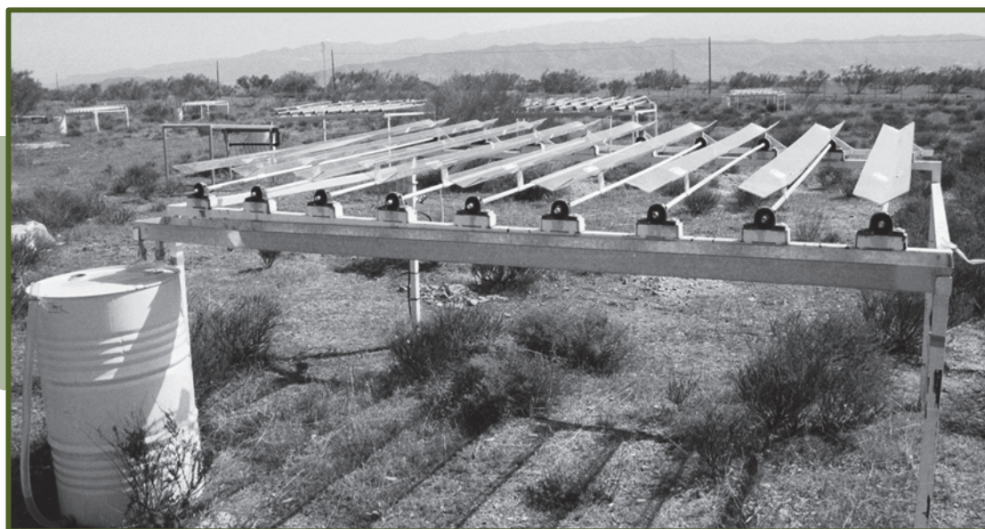
Figura 1. Ejemplo de una de las estructuras de exclusión de lluvia instaladas en Tabernas (Almería, SE España). Las bandas de policarbonato se encuentran en posición de intercepción de lluvia.
