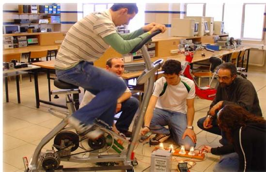
Pruebas para el almacenamiento de la energía generada.
