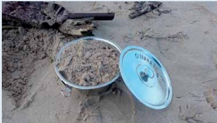
Además, se toma una pequeña muestra inalterada (determinación de fracción < 1 mm).
