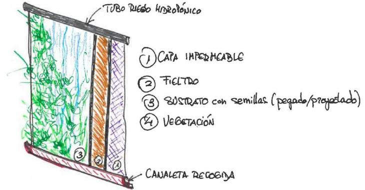
Solución integral de bajo espesor para crear áreas de sombra, tanto horizontal como verticalmente. Sistema de riego hidropónico.
