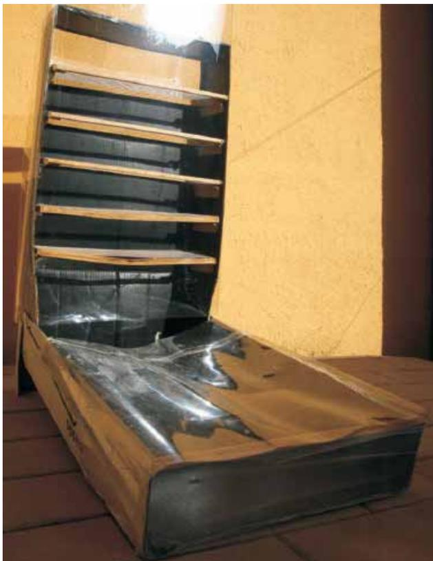
La parte horizontal apoyada sobre el suelo hace de 'colector', donde se acumula el calor y está ligeramente levantada con unas patitas hechas con cartón doblado y encolado lo que ayuda a la circulación del aire. El frente está cubierto por un trozo de visillo para impedir que nuestro artefacto se convierta en la despensa de hormigas u otros visitantes indeseables.
