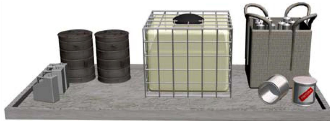
Cubetos impermeabilizados para almacenamiento de residuos peligrosos
