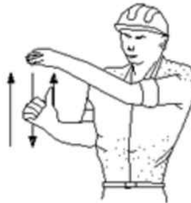
4 LEVANTAR EL AGUILÓN O PLUMA LENTAMENTE
