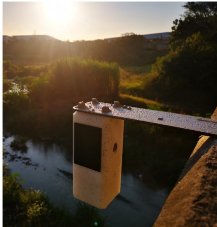
Figura 2. Fotografía del sensor de nivel del mar.
