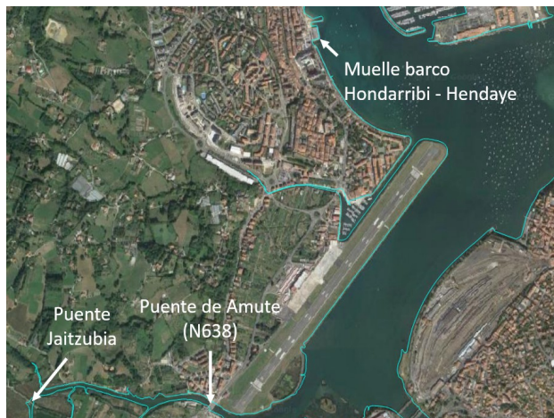
Figura 1. Localización de los 3 sensores de nivel instantáneo del mar.
