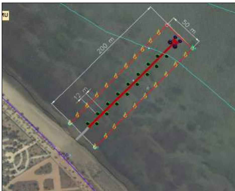
Así mismo y con objeto de asegurar el correcto uso de la infraestructura, el pantalán se emplazará en el interior de un canal de navegación de 50 metros de ancho y una longitud de 200 metros. Es necesario destacar que este canal de navegación ya fue autorizado con anterioridad por parte de la demarcación de Costas de Murcia.
