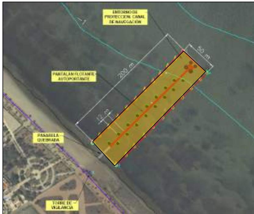
Para la entrada en el canal de paso, se balizará por medio de una boya cónica de color verde para estribor y una boya cilíndrica de color rojo la de babor en el sentido convencional de balizamiento.
