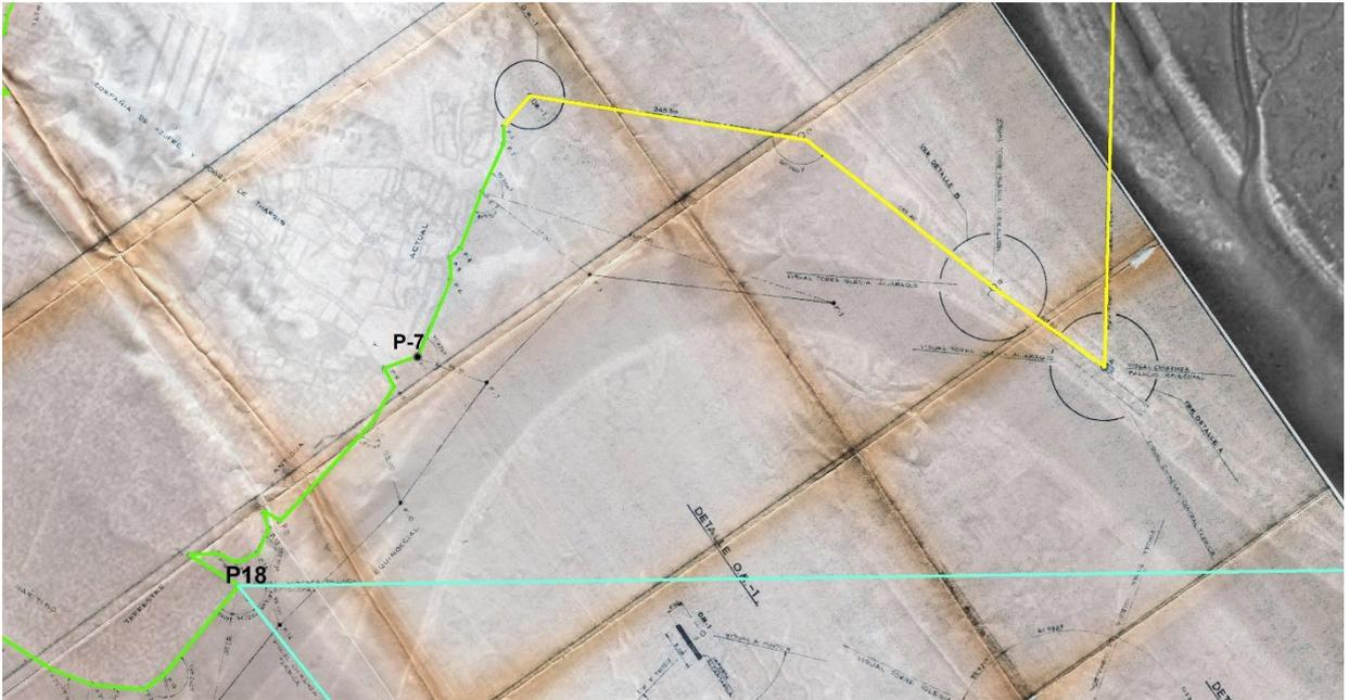
*Poligonal del inicio del deslinde con detalle del vértice P7 reflejada sobre el Plano de Deslinde ZMT de 1976 y sobre ortofoto de vuelo 1956/57*
