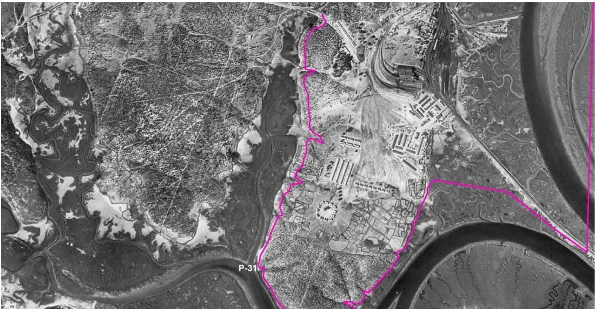
*Detalle de la poligonal sobre ortofoto de vuelo 1956/57, observando el error en la alineación a partir del vértice P31*
